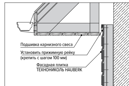
Рис. 9.1. Монтаж верхнего ряда под карнизным свесом
